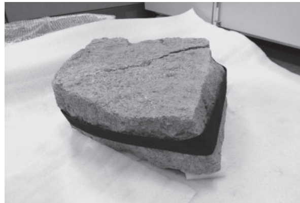
사진 24. 고정끈을 이용한 경화
