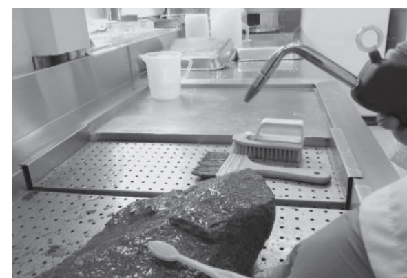
사진 20. 스팀세척기를 이용한 습식세척
